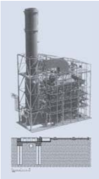
Abbildung 14: Kessel und Kamin mit zugehöriger Fundierung (KW Csepel II in Budapest)
