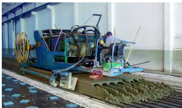
**Abb. 5.18** Betonieren einer Hohldiele im Spannbett
