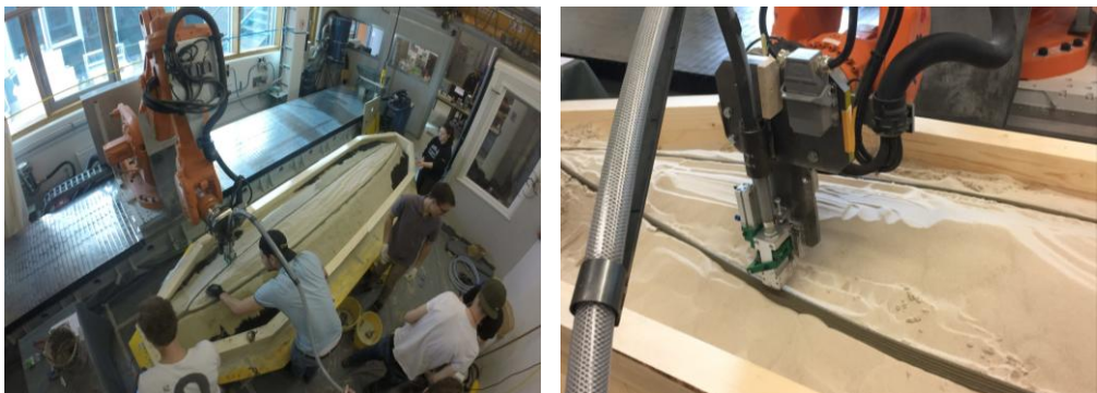
Abbildung 10.3-1: erstes 3D gedrucktes Betonkanu der TU Graz 2017 (Extrusionsverfahren mit seitlicher Sandstützung) [Betonkanu TU Graz - Laggner]
