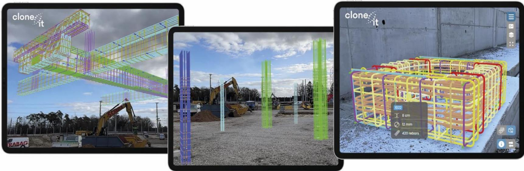
Das Modul *inform* ist besonders hilfreich bei der Verlegung von Bewehrungen, da das Modell direkt in die Schalung projiziert und die Bewehrungsstäbe danach verlegt werden können. Ausführungsrelevante Informationen können durch einen Klick abgerufen werden.
