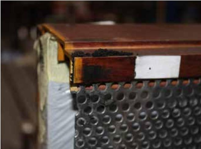
Bild 9: Visuelle Bauteilkontrolle nach 5 Mio. Lastwechseln
