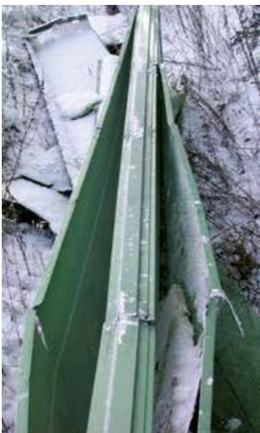
Bild 1: Bruch an der Nahtstelle (Bild aus [4])
